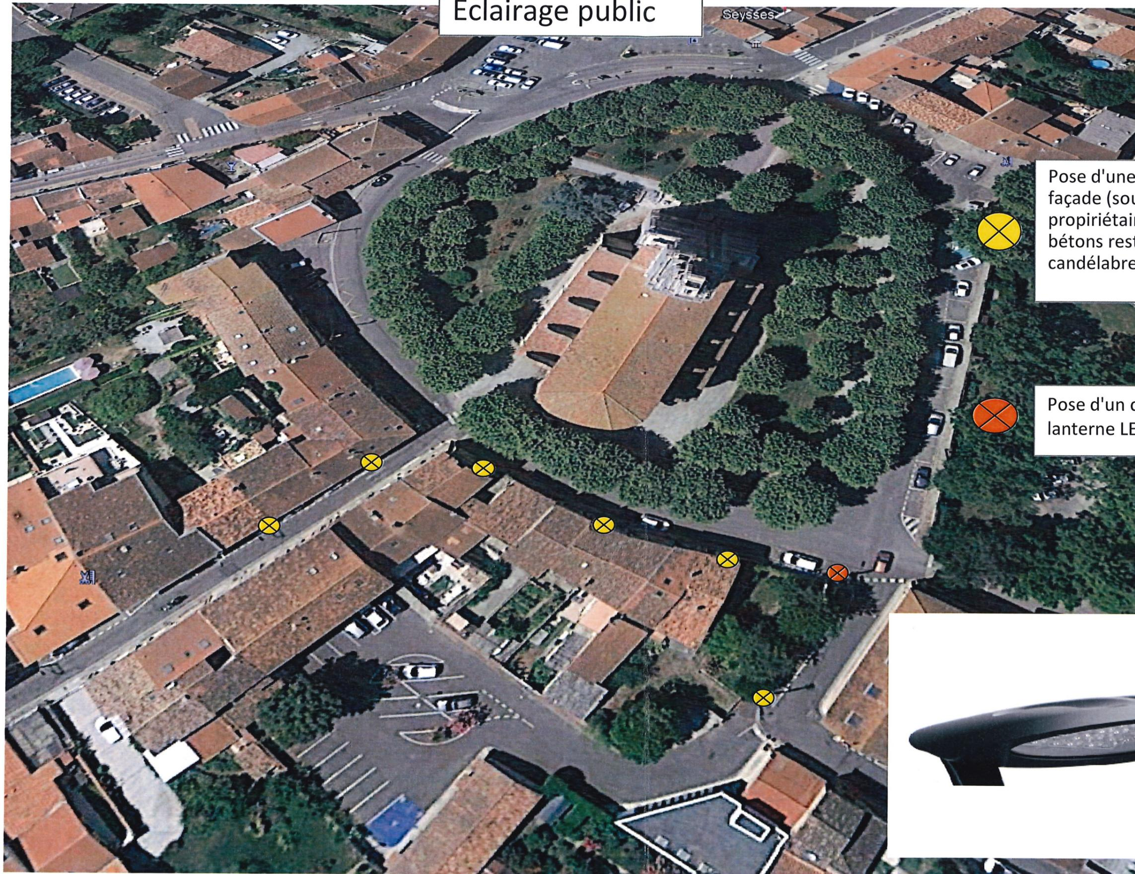
Pose d'une lanterne LED sur façade (sous réserve accord du propriétaire) et sur les supports bétons restant ou pose des candélabres si refus des
